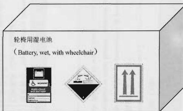
图 B.3 非防漏型电动轮椅、助动器的电池包装外部标记和标签
